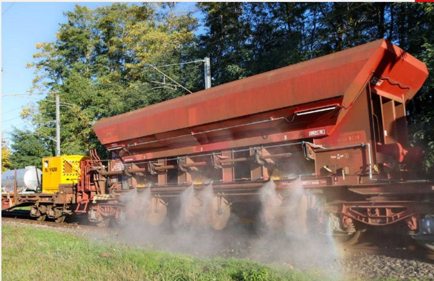
En 2021, Novium a réalisé une campagne d'essais pour trouver la solution optimale d'abattage de poussière sur les chantiers, avec le soutien de SNCF Réseau. Dans la continuité de notre démarche commune, Novium équipe actuellement une rame de 10 ballastières en collaboration avec son client.
